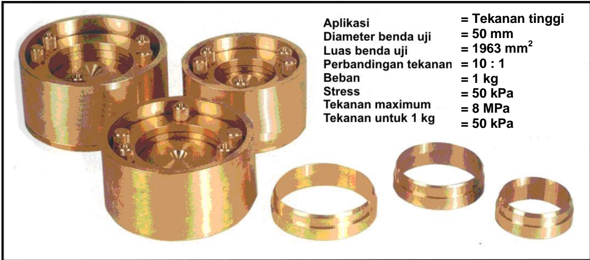
Gambar 1 (c) Cincin konsolidasi dan pencetaknya
